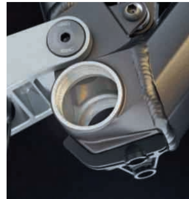
Das fertige Design des Tretlagers muss auch die Formsprache des Herstellers sowie die Produzier- und Wartbarkeit berücksichtigen.
